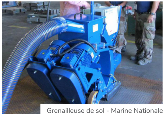
Grenailleuse de sol - Marine Nationale
