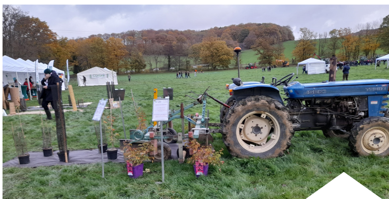
Dispositif utilisé par les pépiniéristes pour implanter des bâches de protection pour la plantation de haies sur de grandes longueurs.
